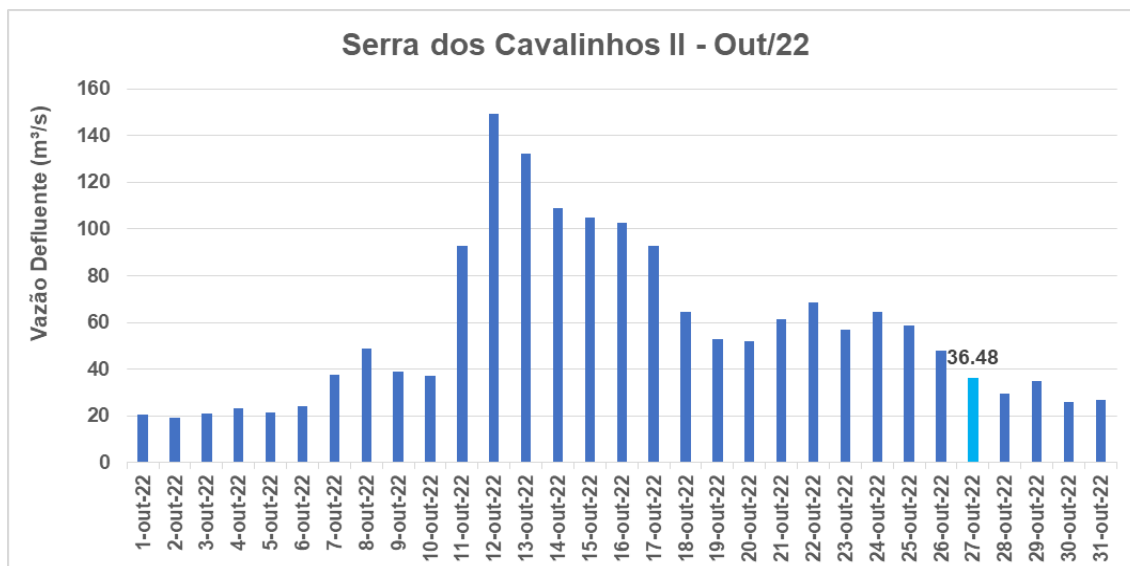
Figura 4-8. Variação da vazão média diária defluente da PCH SCII – Out/22, destacando o período de coleta.
